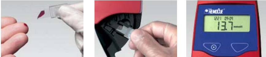
Figure 20 : Mécanisme de mesure du taux d'Hb par l'appareil HemoCue 201+
