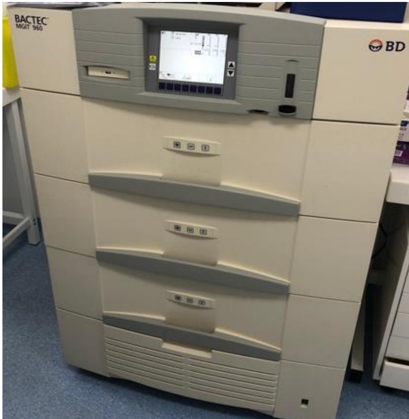
Figure 8: Photographie de l'automate BACTEC® MGIT® de culture des mycobactéries (Photo personnelle Date :07/11/2021)
