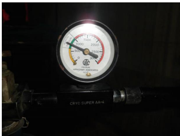
Figure 26 : Gaz de cryogénie. L'aiguille du manomètre doit être dans la zone verte.
