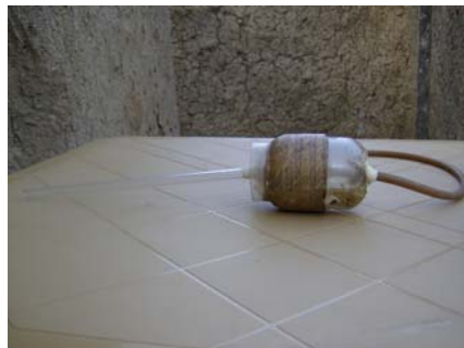
Figure 9: Aspirateur type Coluzzi et Petrarca (1973)
