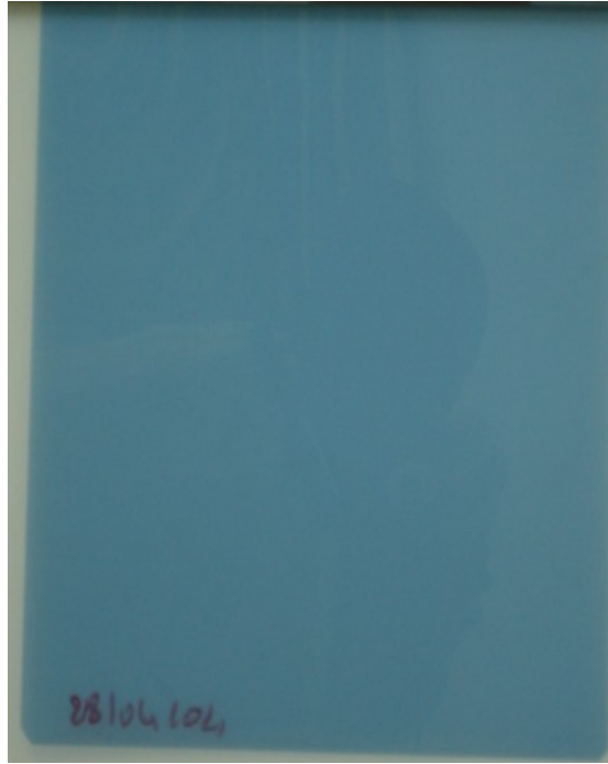
Figure 11 : film voilé par exposition à la lumière.
