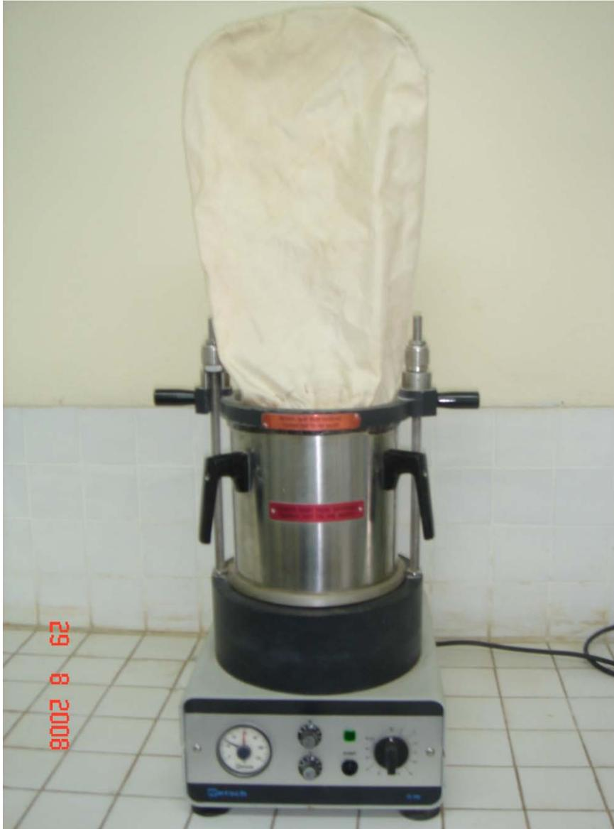
Photo 24: Lit d'air fluidisé RETSCH TG 100
