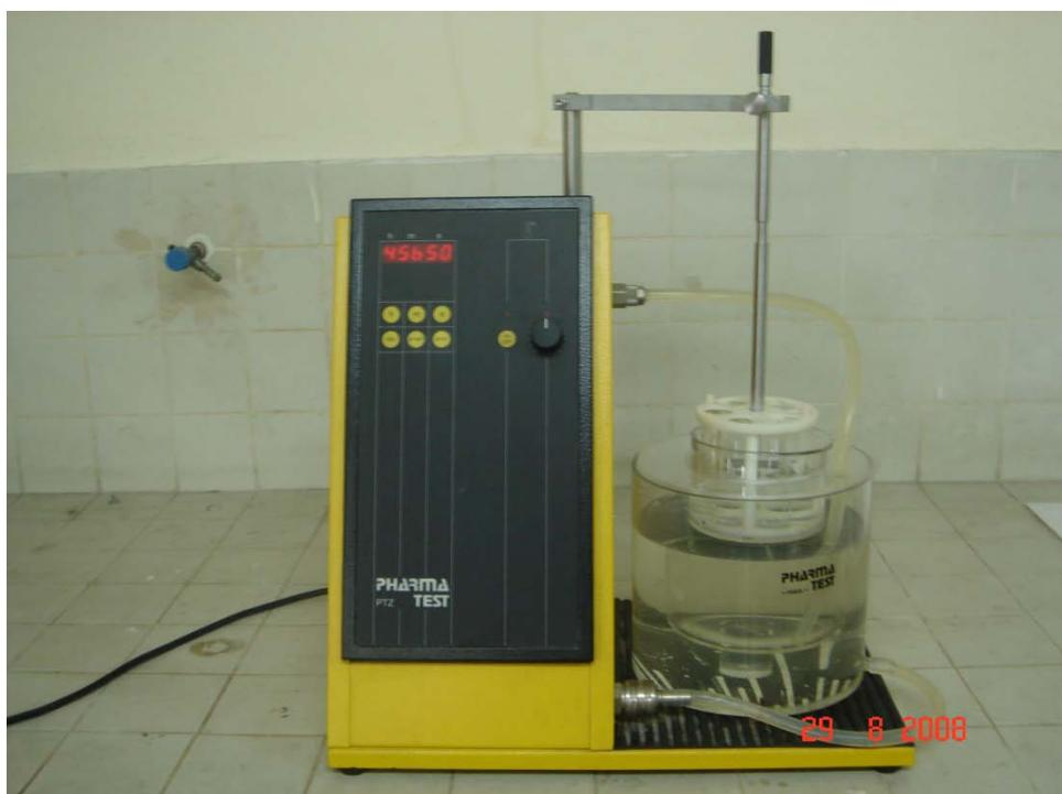
Photo 21: Délitest PHARMATEST type PTZ N°6027 (Allemagne).
