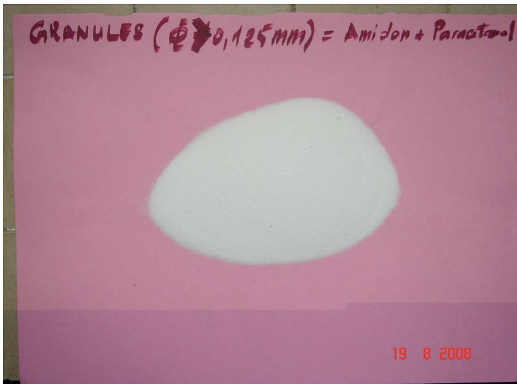
Photo 11: Granulés de XSR de diamètre supérieur à 0,125mm
