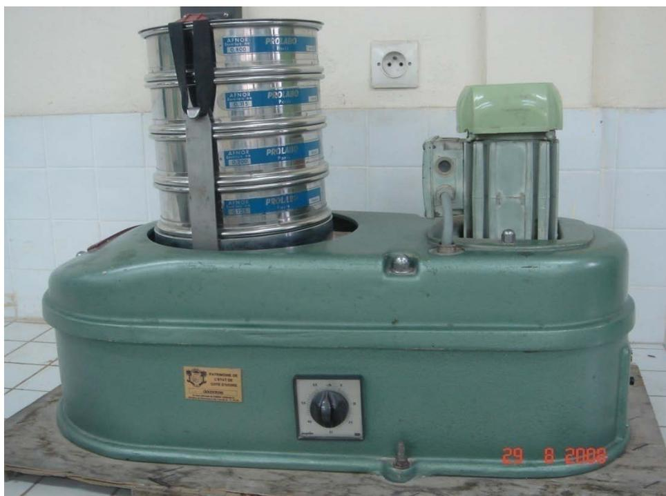
Photo 20: Tamiseuse type ROTO-LAB de chez CHAUVIN n°80652 (France)
