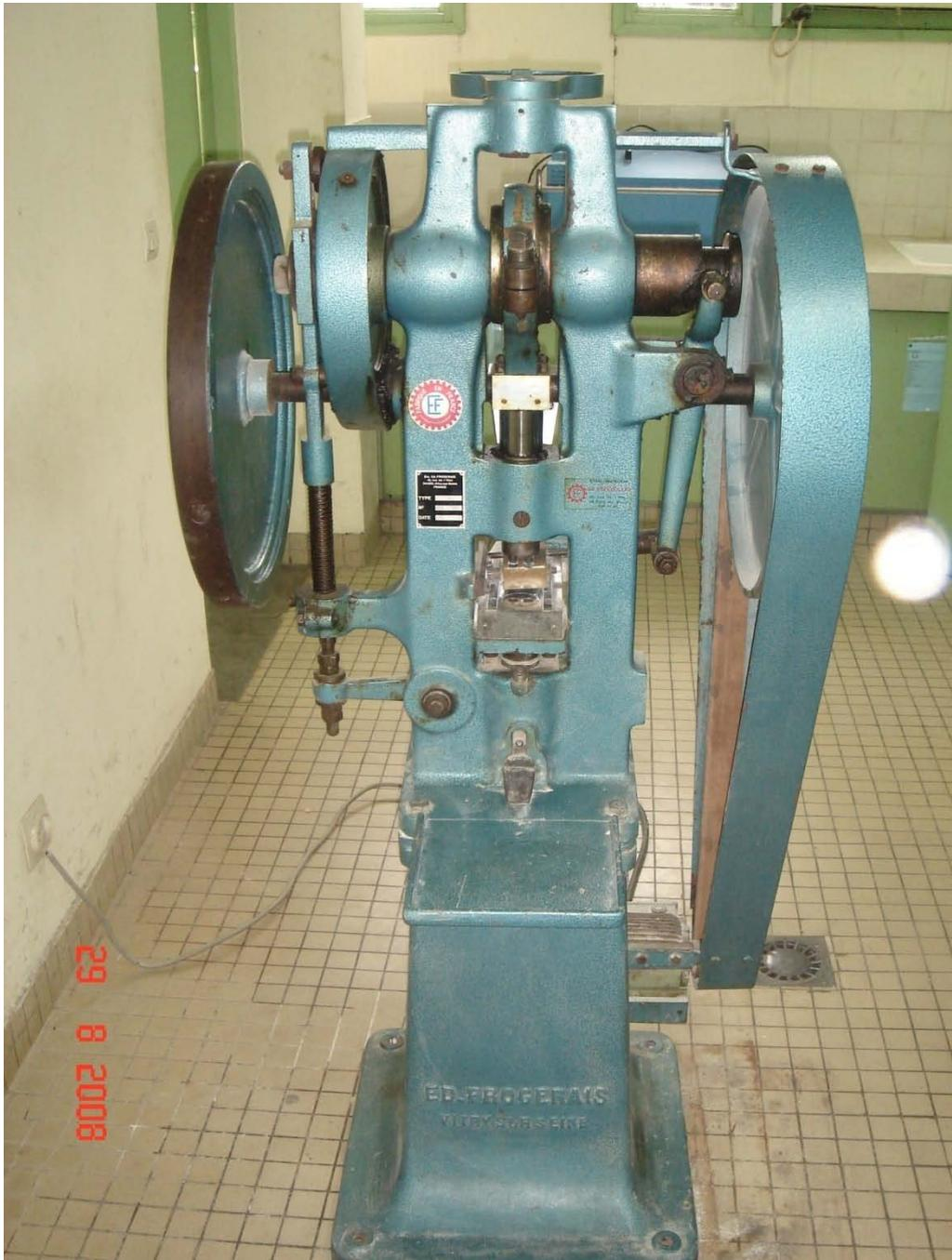
Photo 26: Machines à comprimer à fonctionnement alternatif de chez FORGERAIS type OA n°44138400(France) munie de deux poinçons.
