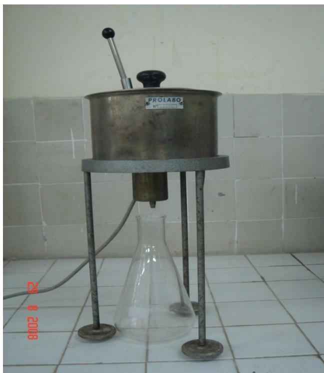
Photo 17: Viscosimètre d'Engler type prolabo
