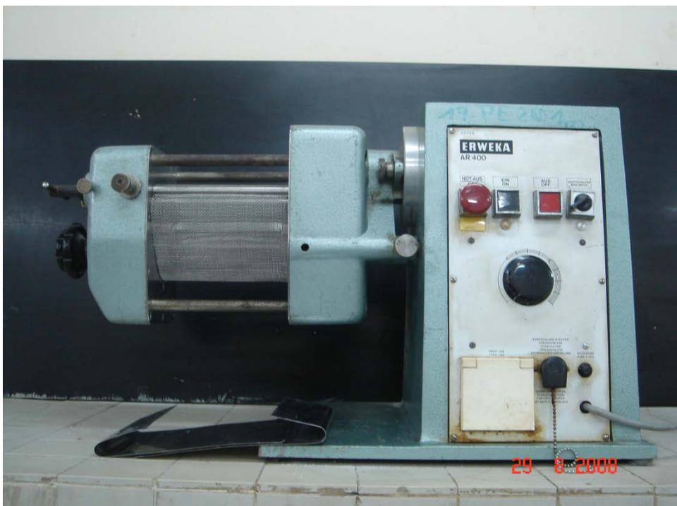
Photo 19: Granulateur à palette ERWEKA type FGS n°47649 (Allemagne), muni d'un moteur ERWEKA type AR 400 n°48581(Allemagne).
