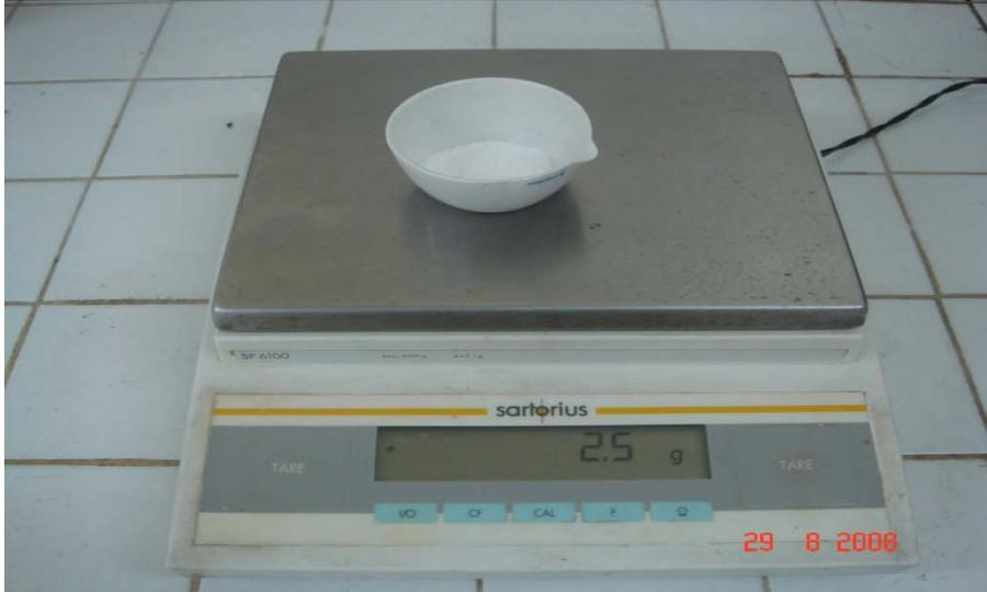
Photo 14: Balance de précision SARTORIUS type BP6100 n°60706671 (Allemagne), (à affichage digital au 10<sup>e</sup>)
