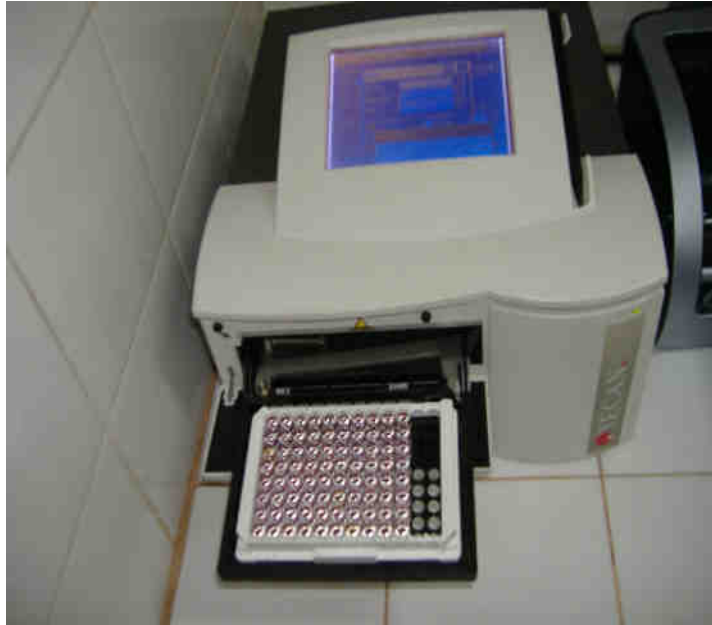
fig4 : Spectrophotomètre pour lecture des plaques des densités optiques à 450/620-700 nm.
