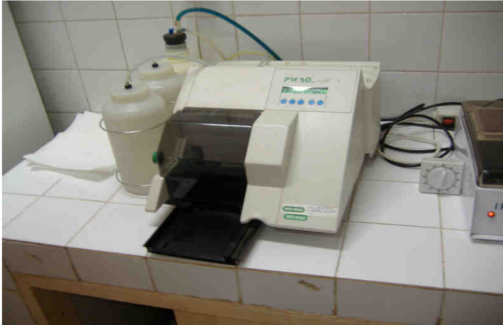
fig 5 : Laveuse automatique des microplaques d'échantillons
