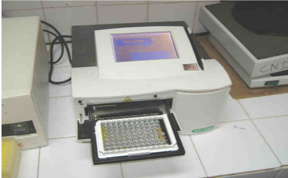
fig 6: Spectrophotomètre contenant des échantillons positifs de couleur jaune au GENSCREEN HIV 1/2 Version 2
