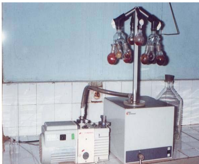
Figure n°19 : Photo du lyophilisateur utilisé pour sécher nos extraits aqueux
