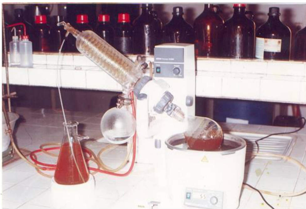
Figure n°18 : Photo du rotavapor utilisé pour sécher nos extraits aqueux.
