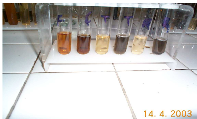
FIGURE n° 26: Photo des tanins : Réaction avec FeCl_3 après saturation par l'acétate de sodium pulvérisé.
