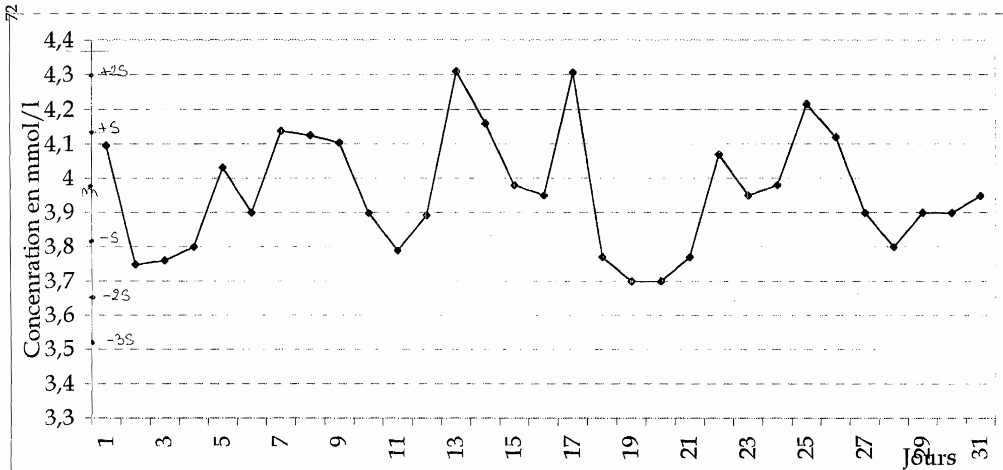
Fig. n°18: Graphique des résultats du contrôle de qualité jour après jour du cholestérol de février à mars 1999, moyenne 3,96 mmol/l, écart type 0,17.
