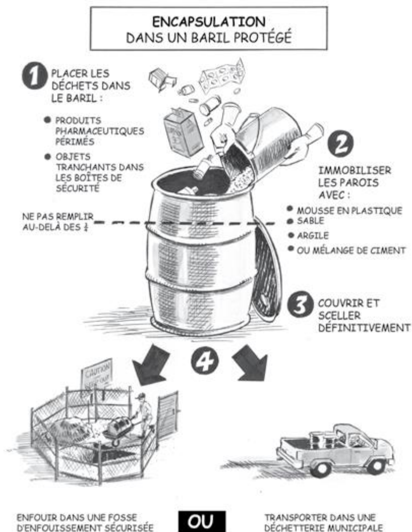
Figure 4: Méthode d’encapsulation source (inspire de : guide de gestion des déchets de soins médicaux à l’attention des travailleurs de santé communautaires)
