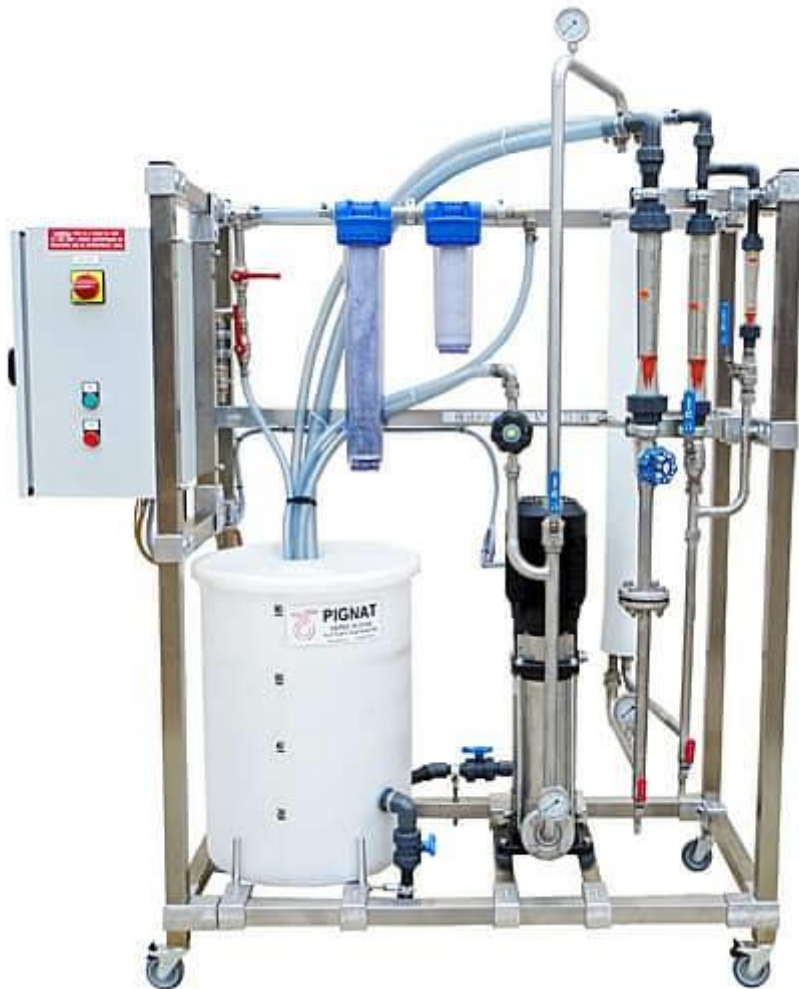
Figure 3: Station de traitement d'eau pour hémodialyse [25]
