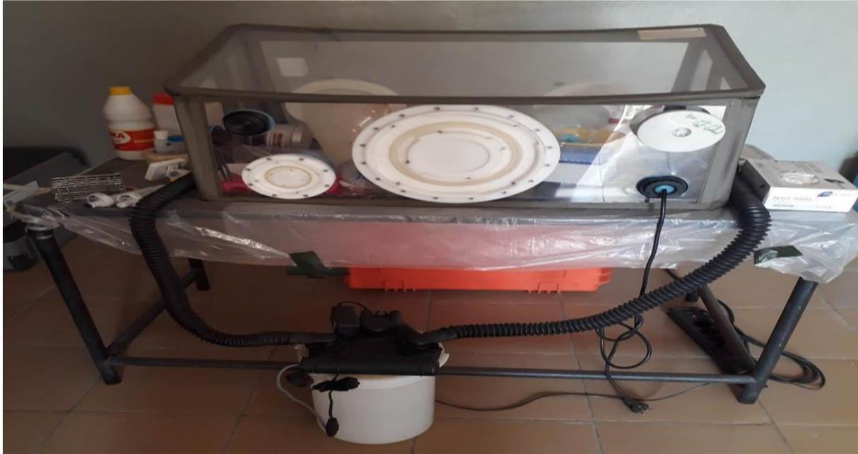
**Figure 9 : Boite à gant pour inactivation des échantillons [52].**
