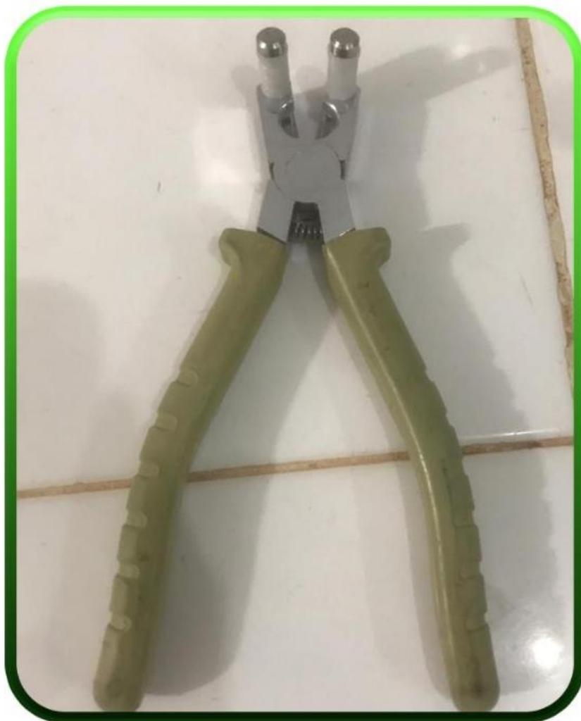
*Figure 17 : Strippeuse de tubulures (Photo prise au CNTS de Bamako)*
