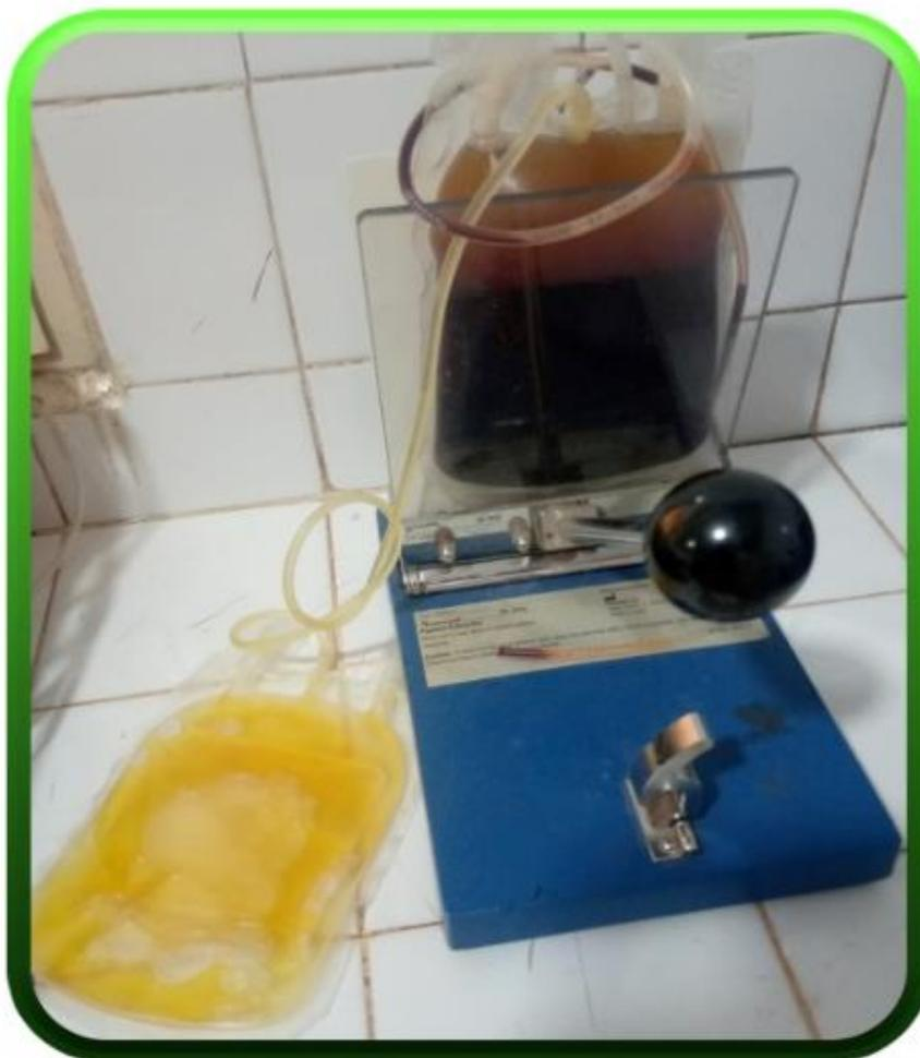
*Figure 12 : Presse manuelle GENESIS (Photo prise au CNTS de Bamako)*
