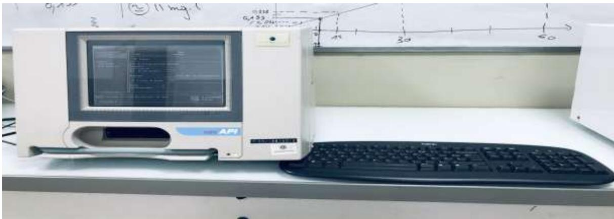
**Figure 12 :** Automate mini Api pour la lecture de galerie (Photo prise au LRM le 04/10/2019).
