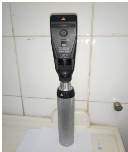
Photo5 : Image montrant le skiascope portable utilisé pour la réfraction (image du service)
