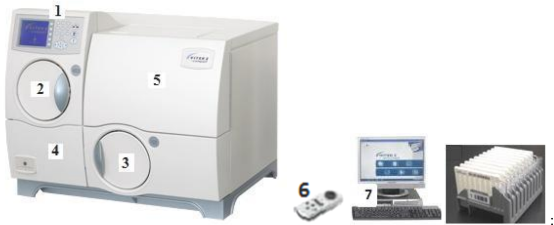
Figure Automate d'identification et d'antifongogramme Vitek 2
