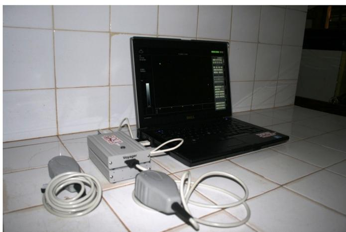
*Figure 21 : l'échographe portable connecté à l'ordinateur*
