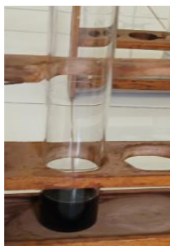
Figure 5 : Photographie de l'essai de caractérisation de l'acide salicylique libre [27,28].
