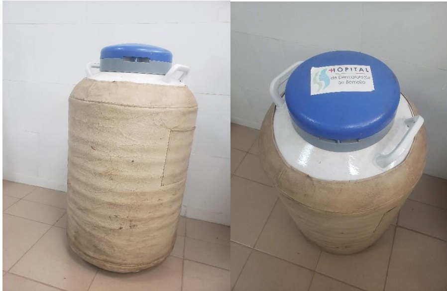
Figure 3: Image Container auto pressurisé de conservation de l'azote ( Photo prise à l'HDB )
