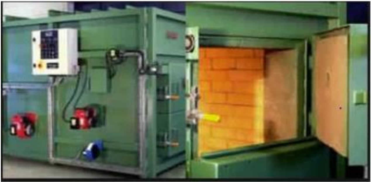
Figure 4 : Image d'un incinérateur (25)
