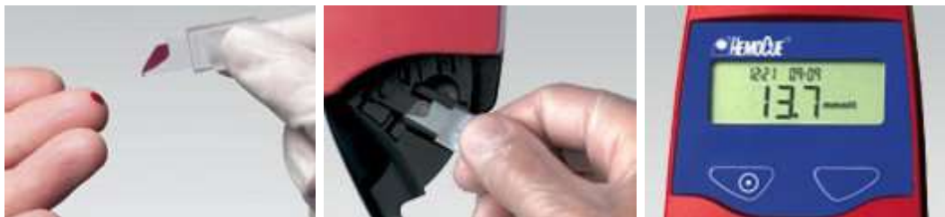
Figure 16. Mécanisme de mesure du taux d'Hb par l'appareil HemoCue 201+
