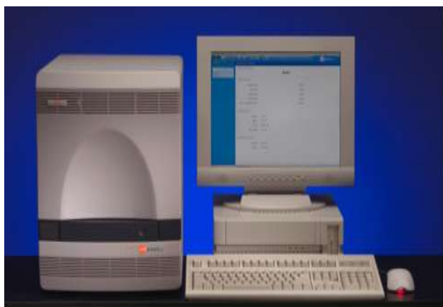
Figure 11 : appareil Abbott m2000rt pour l'amplification/détection (ARN-VIH et ADN-VHB)
