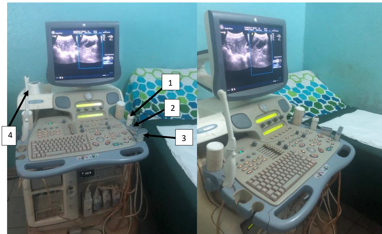
Figure 18 : appareil d'échographie marque Vivid 7 D avec quatre sondes cardiaque(1), superficielle (2), profonde (3) et endocavitaire (4)
