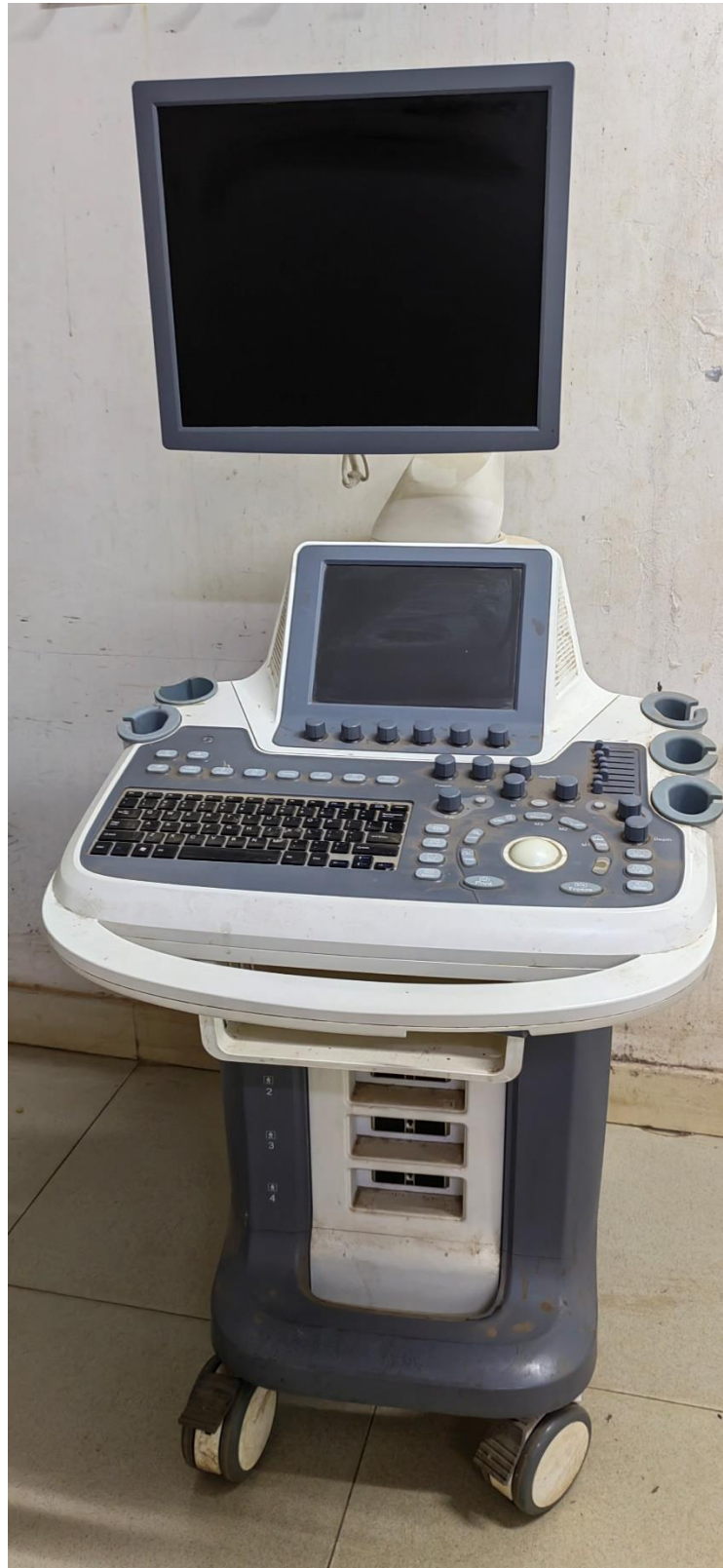
ESSE 3 , installé en 2017 avec quatre (4) sondes (convexe [3-8MHz], linéaire [10-15MHz], endocavitaire [3-9MHz]).
