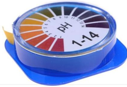
Figure 17 : Rouleau pH 5m 1-14 de la marque Sigma pré-lab.
