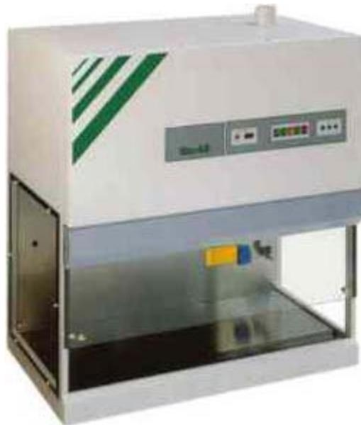
**Figure 6 : Hotte à flux laminaire vertical**
