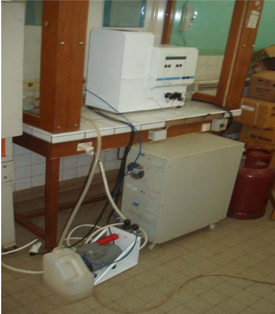
Figure 10: **Photo de l'appareil permettant le dosage des ions Sodium et Potassium (INRSP)**
