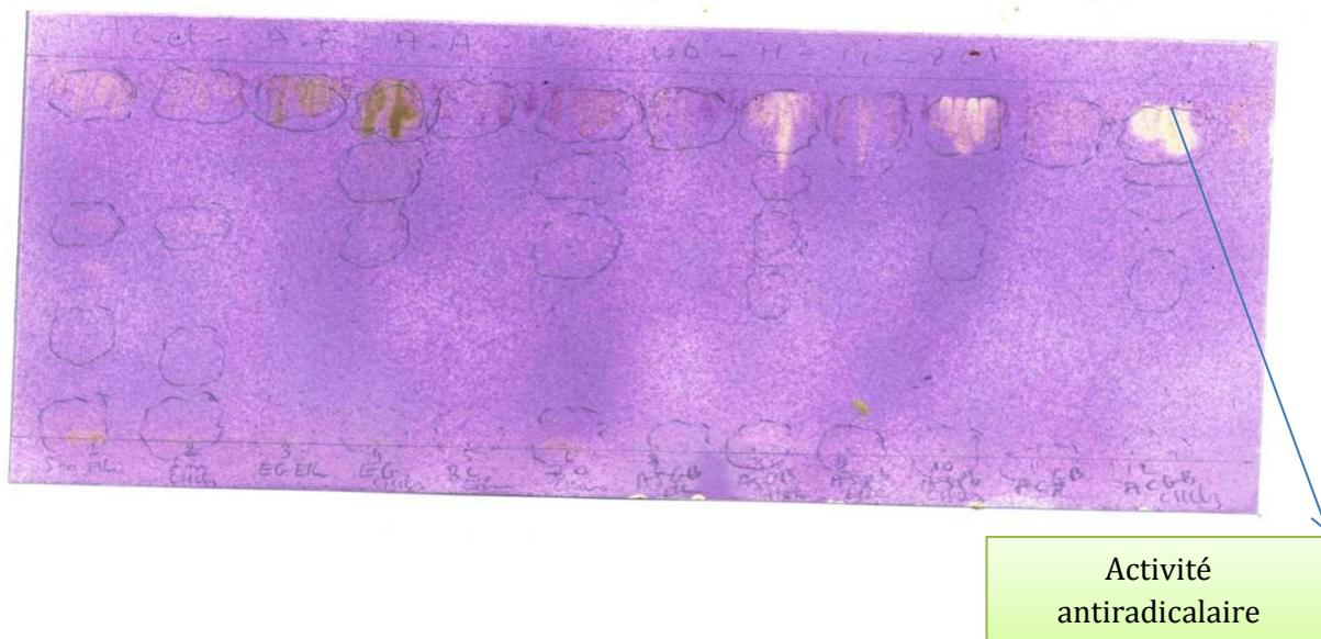
**Figure 33 :** Chromatogramme A des extraits étherés et chloroformiques dans le système de solvant Acétate d'éthyle : Acide formique : Acide acétique : Eau (100 :11 :11 :26) révélé avec DPPH
